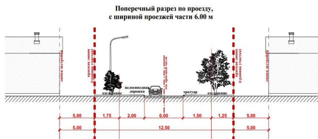
Рис.2 Пример профиля проезда в составе акта красных линий.
